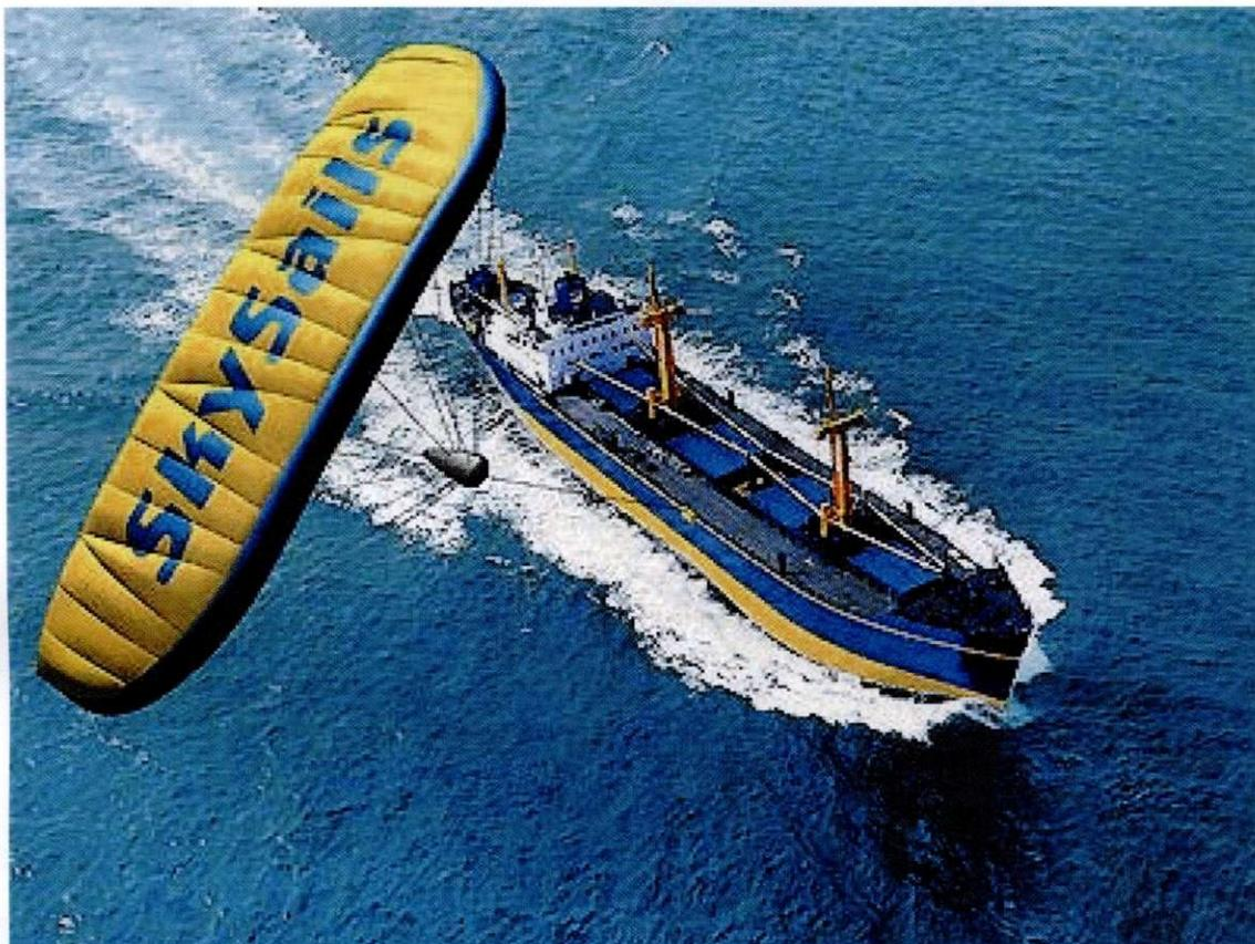
Des calculs théoriques prédisent, en conditions de navigation et de vent idéales (grand large et mer plate), jusqu'à **50 % d'économie de carburant grâce à un cerf-volant** tirant le navire qu'il survole.
