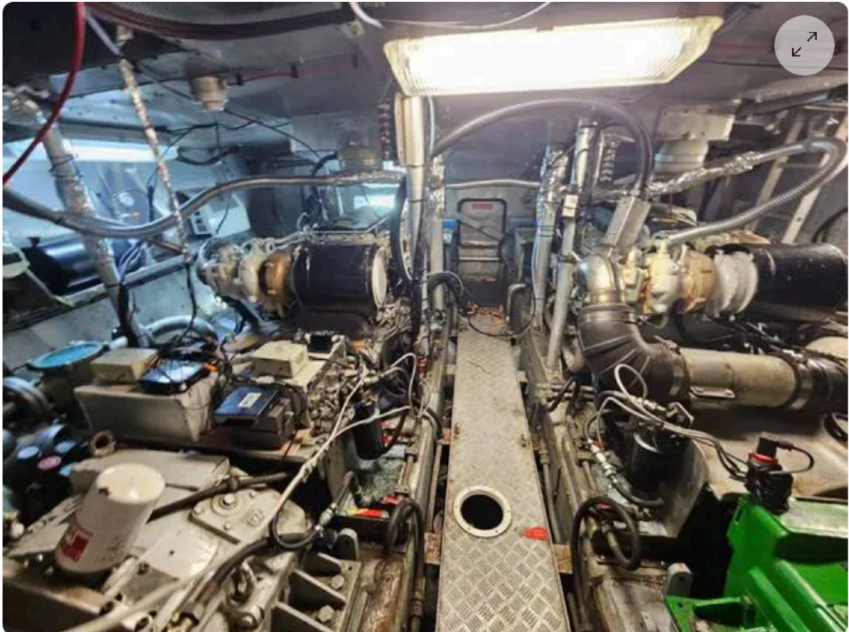
Les deux moteurs de la vedette "Penn Sardin". L'un fonctionne partiellement avec du biocarburant, l'autre uniquement au carburant fossile. | DR
