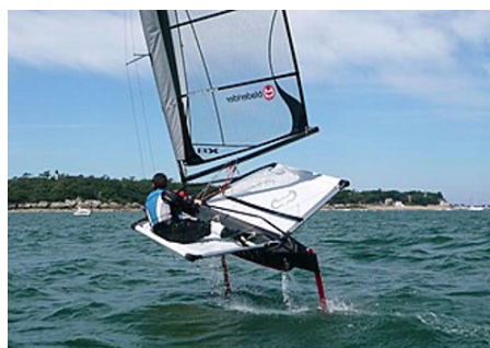
Le foil en « T » du Moth. Source : Wikipédia
